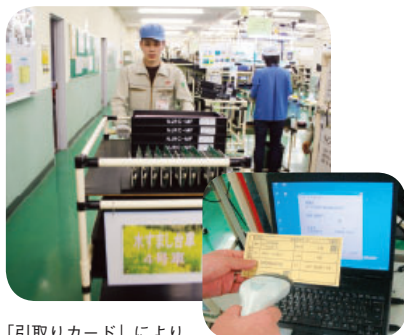
「引取りカード」により 部材、製品を運搬する「みずすまし」
