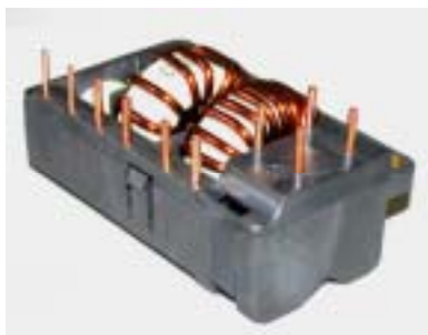
自動巻線機で生産のトロイダルコイルと巻線作業の様子
