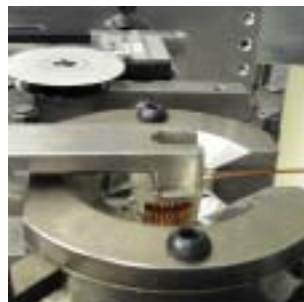
自動巻線機で生産のトロイダルコイルと巻線作業の様子
