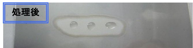
■油分除去、接着性向上処理例 (素材:無洗浄ステンレス板)
